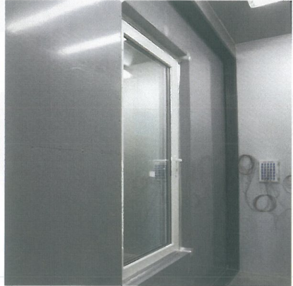
<사진 2> 열관류율 저온측 시험체 모습
