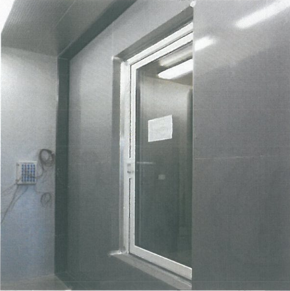
<사진 1> 열관류율 항온측 시험체 모습
